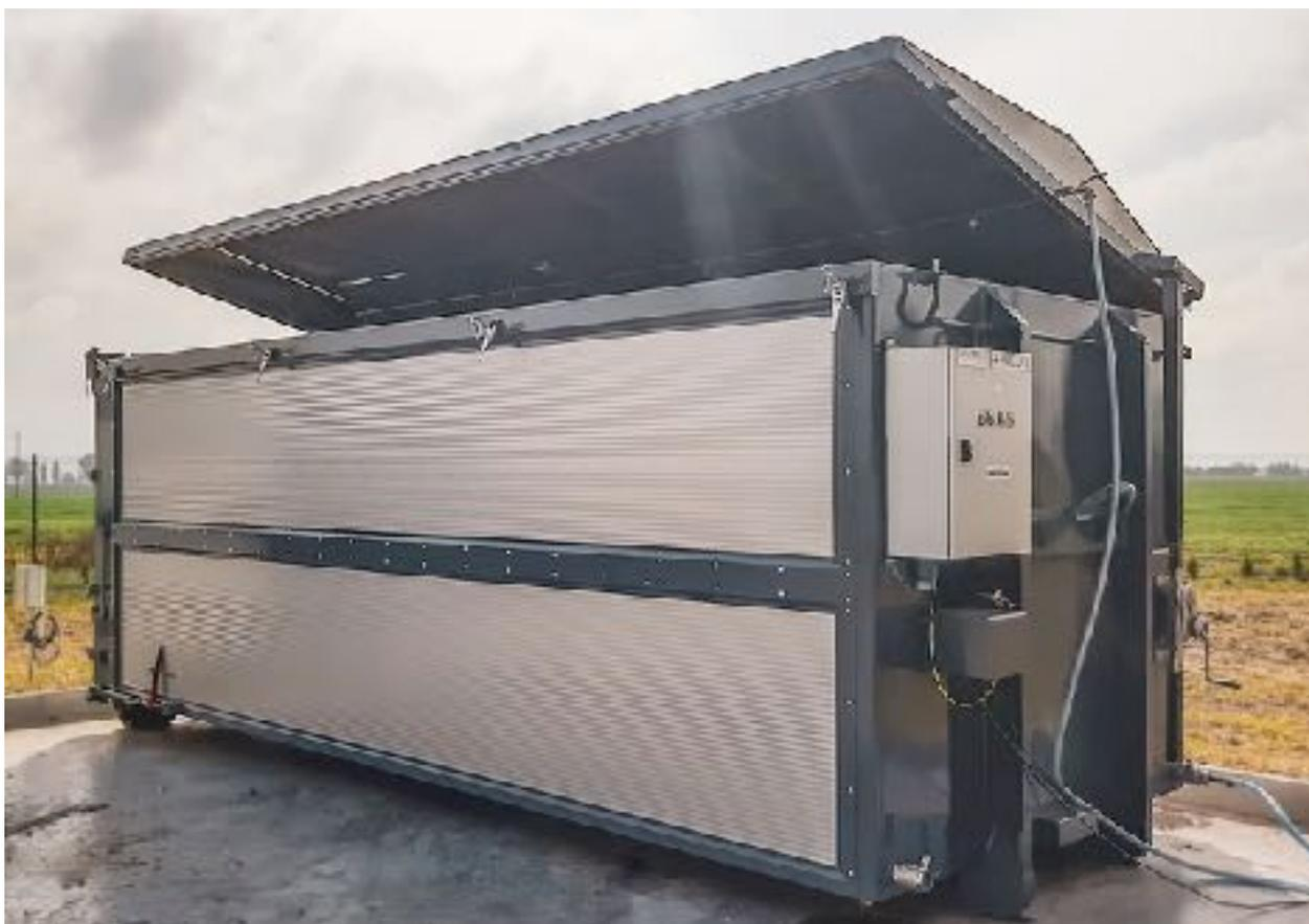
Рис. 6. Мобильный реактор для компостирования фирмы Compost Systems<sup>7</sup>
