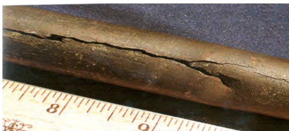
Рис. 1. Результат воздействия водорода на обычную сталь
