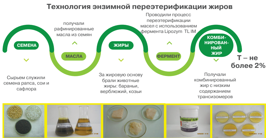
Рис. 42. Технология энзимной переэтерификации жиров Источник: презентация А.Б. Далабаева.
